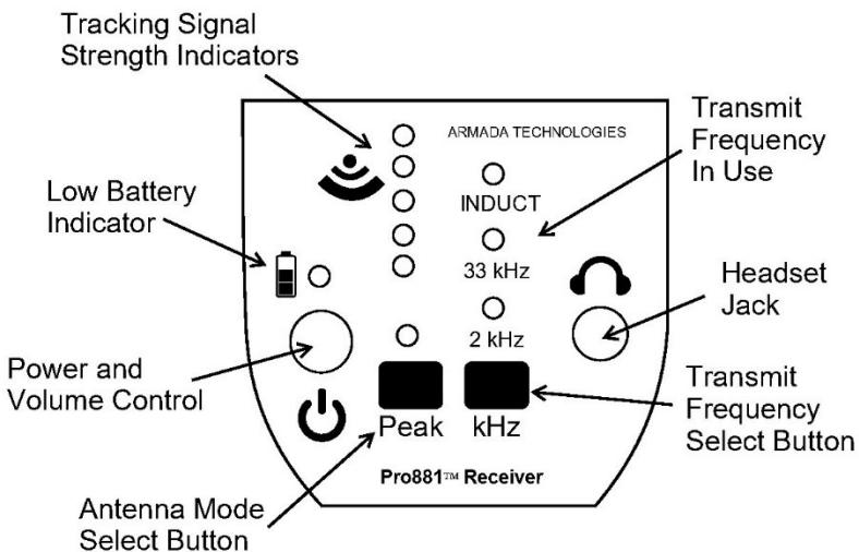
**Funcionamiento del receptor** - Encienda su receptor girando el control de volumen en el sentido de las agujas del reloj. Una vez más, el estado de la batería se indica mediante la luz situada directamente arriba del dial de encendido (luz apagada = batería en buen estado, luz encendida = batería baja).
